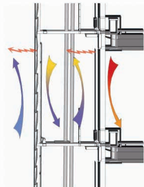
Doppia Pelle – Limitazione delle Perdite Termiche
