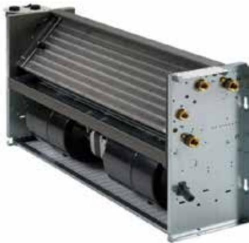
La struttura interna di un ventilconvettore. L'aria viene aspirata dai ventilatori nella parte inferiore, passa attraverso il filtro e la batteria, riscalda o raffredda, e viene quindi immessa in ambiente. L'apparecchio può essere ricoperto da una cofanatura in lamiera verniciata oppure essere inserito in un elemento di arredo o in una nicchia.
