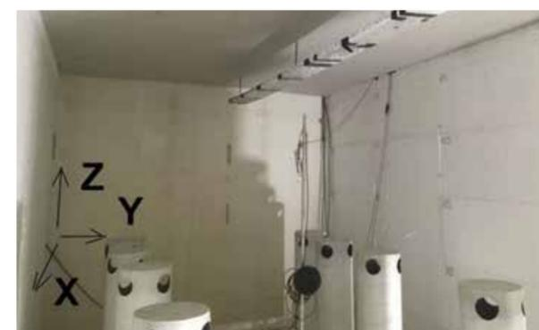
Pianta dell'area di prova nel mock-up di laboratorio, con riportata la mandata e le riprese dell'aria, nonché le aree attrezzate con pannelli radianti (sopra). Sala prove con posizionate le apparecchiature per la simulazione, con i carichi interni in conformità al progetto dell'arredo (sotto).
