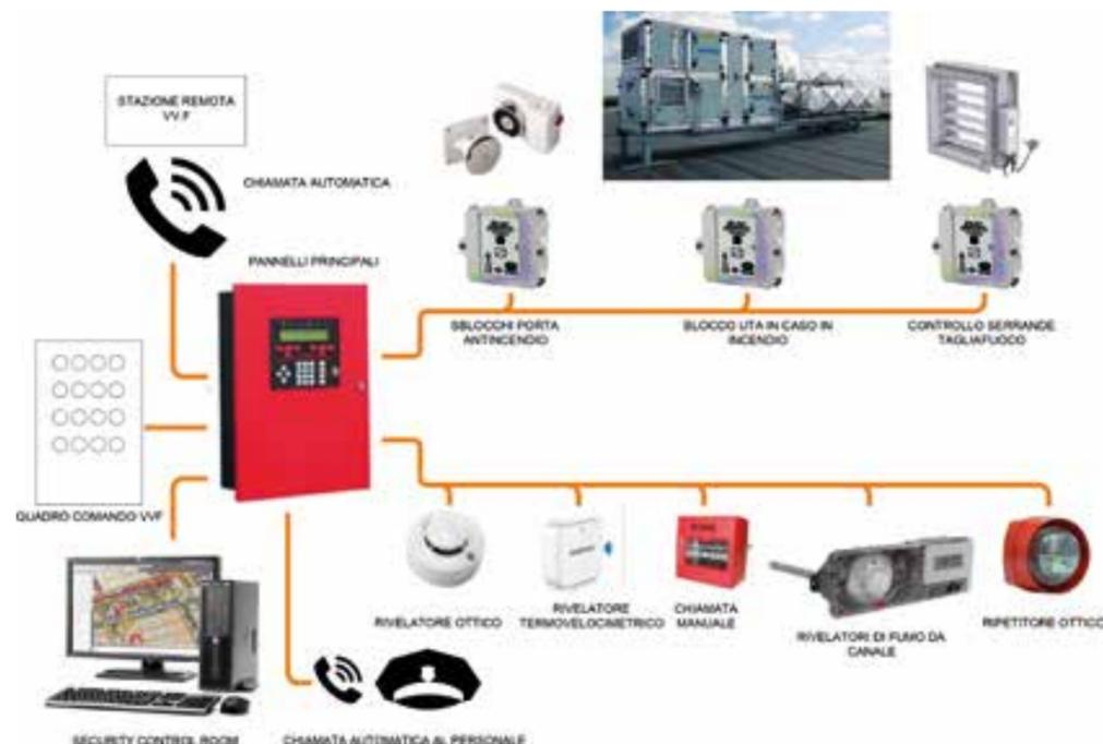
Schema del sistema di rivelazione d'incendio di allarme ottico-acustico.
