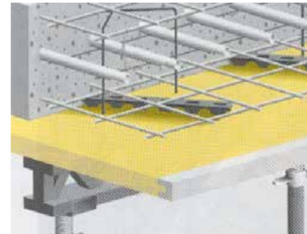
Un sistema radiante "a massa termicamente attiva" (TABS): i tubi sono annegati all'interno di un solaio massivo, tipicamente calcestruzzo, che funge da accumulo termico.
