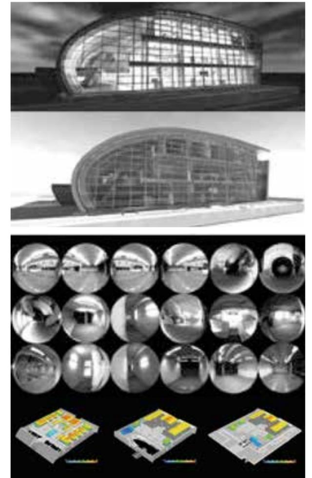
Il software Radiance permette di rappresentare gli edifici dal punto di vista spaziale mediante rendering e di analizzarne le prestazioni dal punto di vista dell'illuminazione naturale e artificiale. Nella figura sono visualizzate alcune verifiche: da sinistra, in senso antiorario, rendering fotorealistico in condizioni di luce artificiale (di notte) e naturale, studio dell'abbagliamento in diversi punti interni e dei livelli di illuminamento.
