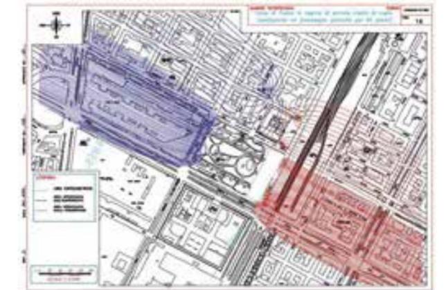
Rappresentazione delle linee di flusso dell'acqua di falda nel mese di luglio; emungimento: linee blu; restituzione: linee rosse.
